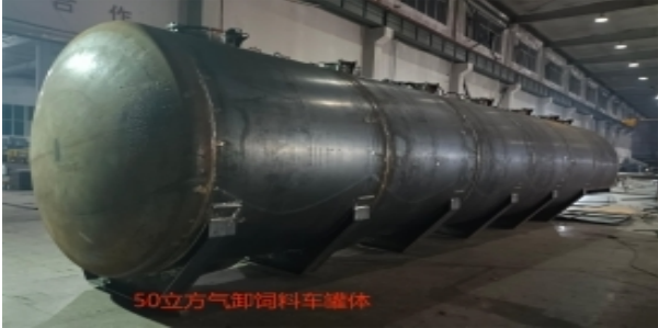
A50罐体，容积：50m 3 ，卸料方式：气压 材质：碳钢，用途：饲料运输
