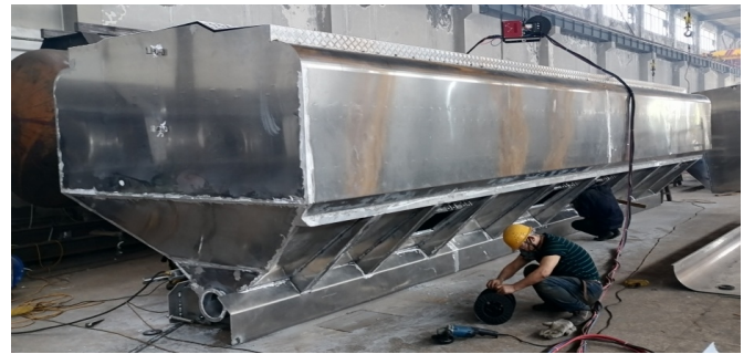
D39D罐体，容积：39m 3 ，卸料方式：绞龙 材质：铝合金，用途：饲料运输
