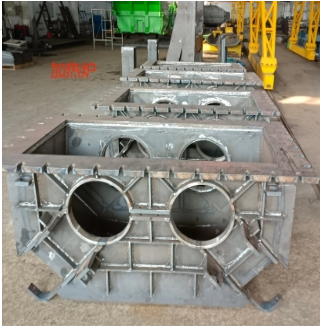
加热炉，用于铜带加工
