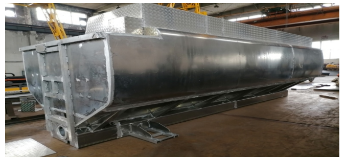
D32D罐体，容积：32m 3 ，卸料方式：绞龙 材质：铝合金，用途：饲料运输
