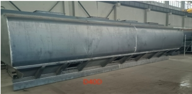
D40D罐体，容积：40m 3 ，卸料方式：绞龙 材质：碳钢，用途：饲料运输
