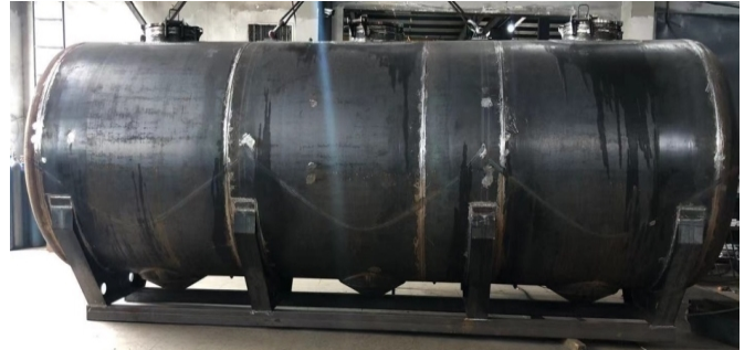
A36罐体，容积：36m 3 ，卸料方式：气压 材质：碳钢，用途：饲料运输
