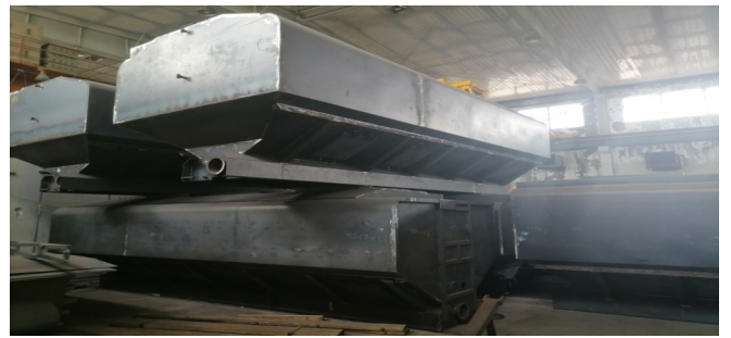
D22罐体，容积：22m 3 ，卸料方式：绞龙 材质：碳钢，用途：饲料运输
